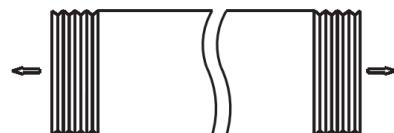
2. Atornille el conducto de salida de aire en el conector del conducto de salida de aire.
