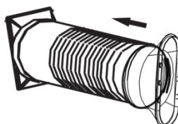
4. Inserte el conector del conducto de salida de aire a la unidad.
