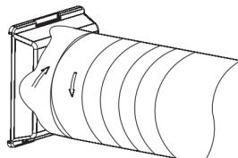
3. Atornille la otra parte del conducto de salida de aire en el adaptador de salida de aire de ventana.
